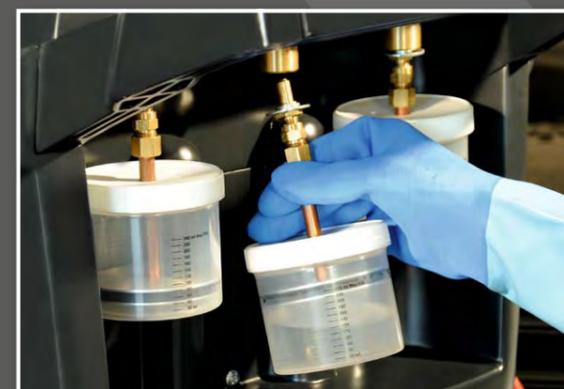
Iniezione tracciante olio o UV, circuito separato (per gli impianti A/C di veicoli ibridi ed elettrici)
