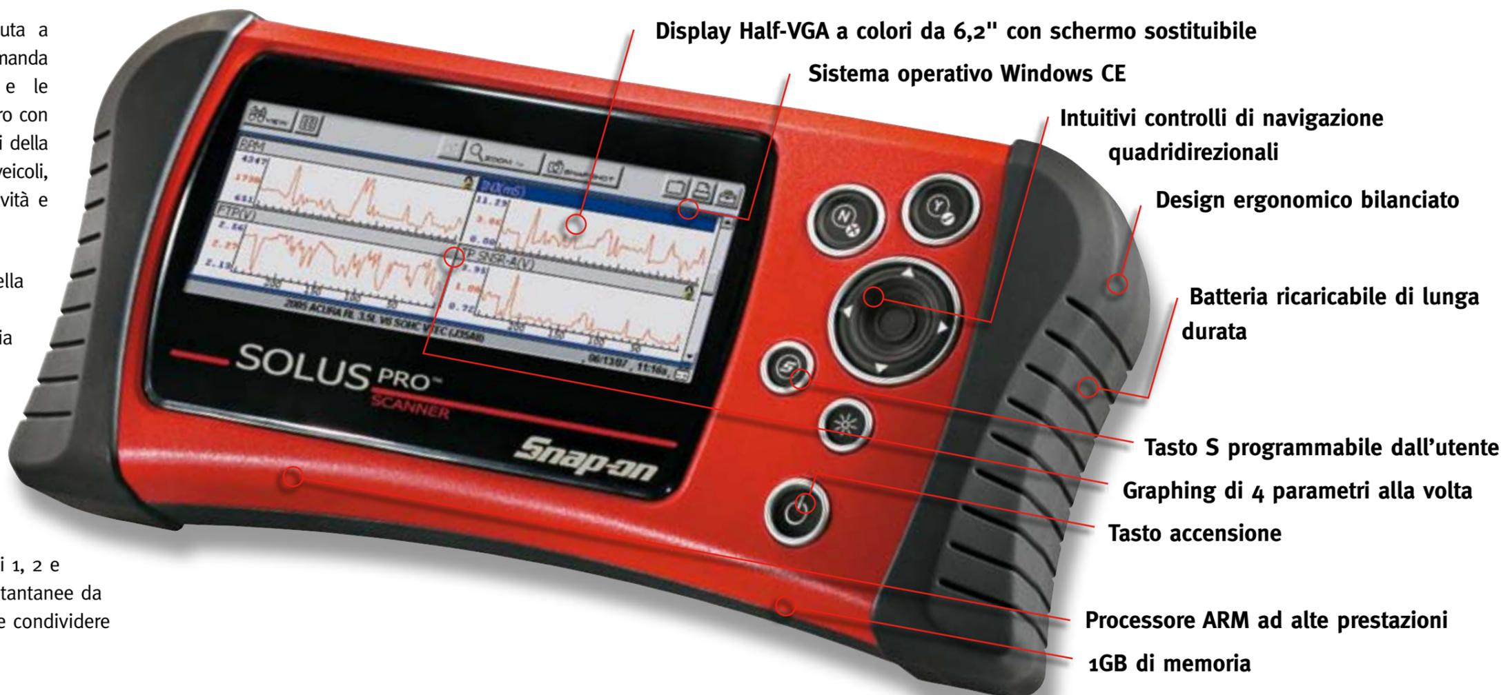
Display Half-VGA a colori da 6,2" con schermo sostituibile
